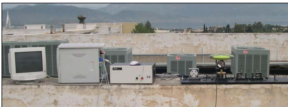
Σχήμα 11. Συσκευή παραγωγής ταλαντώσεων με προσαρμοσμένα όργανο GPS και ανακλαστήρα για RTS
